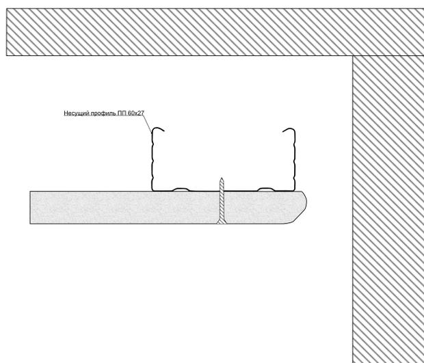
Установите несущий каркас к основному потолку. Если планируется светодиодная лента, сразу выведите провод к месту подключения. Затем установите верхний слой гипсокартона с отступом от стены 20 мм.
